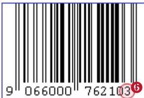
Der EAN13 Code besteht aus 12 Ziffern plus einer Prüfziffer an der letzten Position (6).
