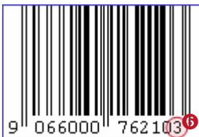
Der EAN13 Code besteht aus 12 Ziffern plus einer Prüfziffer an der letzten Position (6).
